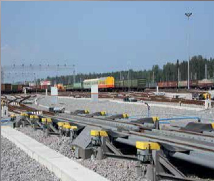
На первой и второй тормозных позициях применены двухрельсовые пружинно-гидравлические вагонные замедлители TW-4F . Энергию торможения обеспечивают пружины, силой сжатия которых управляет гидравлическая система.
